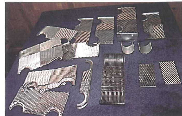
Fot. 10 Przecięty i rozlutowany chemicznie w kwasie azotowym płytowy wymiennik ciepła lutowany miedzią
