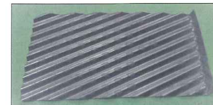
Fot. 12a Awers wycinka płyty z wymiennika płytowego z niedolutowanymi miejscami połączeń (miejscami lutu stanowią ciemniejsze punkty)
