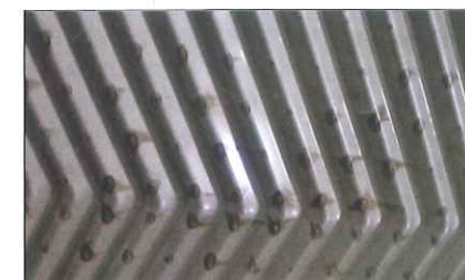
Fot. 9 Uszkodzona wcześniej korozyjnie płyta ze stali 316 L z wymiennika rozbiernego podgrzewającego wodę o jakości wody do picia do temperatury 80°C przy zawartości w wodzie 30 mg Cl - /l
